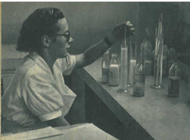
Misura di densità del latte, la quale deve superare i 1030 Bé; il controllo avviene sei volte il mese.
