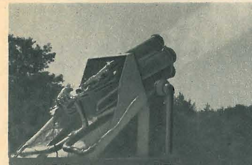
Il motore razzo 6000 C-4 sul banco di prova, con le camere di combustione in funzione simultanea.
