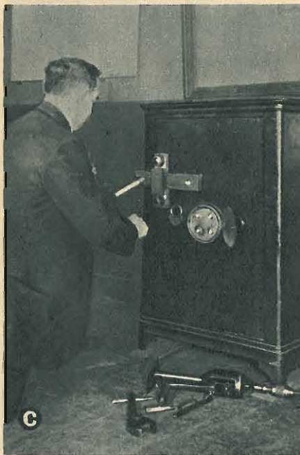
Lo scassinatore, ricava anzitutto nello sportello della cassaforte due fori, alla stessa distanza fra loro di quelli della staffa (A). Servendosi di questa staffa (B), fissa sulla cassaforte il ponte, in modo che un foro praticato in esso oltrepassi lo sportello e venga a coincidere con lo stipite della cassaforte; poi (C), spinge in questo foro una grossa vite che vien fatta girare da una leva e, per conseguenza, fa pressione contro lo stipite. Continuando ad avvitare, lo scassinatore esercita un grandissimo sforzo sullo sportello, strappa il paletto e può aprire facilmente la cassaforte (D).
