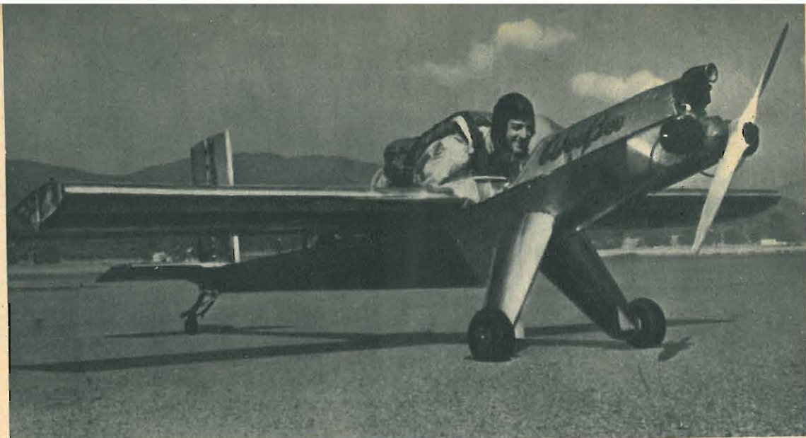
Fig. 3: Il Wee Bee, il più piccolo aereo che si conosca, ha 5 m di apertura alare e 5 di lunghezza. Il pilota è sdraiato sulla fusoliera; un motore di 37 cav conferisce all'aereo una velocità massima di 150 km/h.
