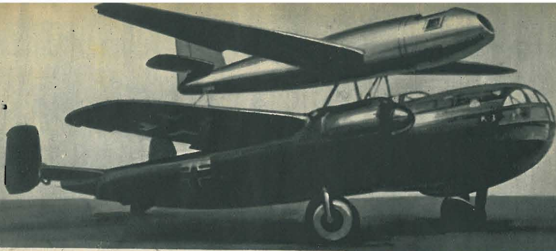
Fig. 4: Il D.F.S.-228 portato da un Dornier-Do, 217 K. Questo aereo da ricognizione fotografica si stacca dall'aereo-portante a 10 000 m d'altezza; un razzo Walter 509-D lo fa salire a 24 000 m. Compiuta la missione, torna alla base a volo librato; l'autonomia così ottenuta raggiunge i 700 km all'incirca.
